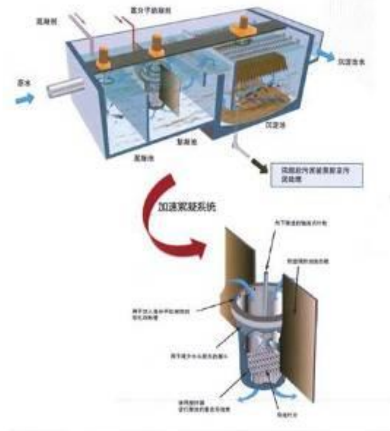
图 3.7-5 高效沉淀池流程原理图
