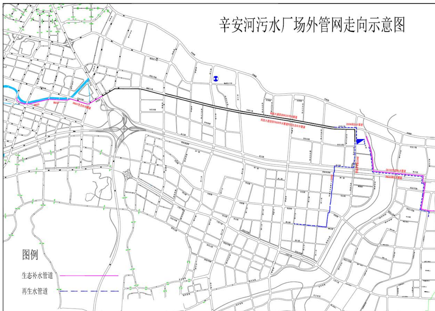
图 3.8-2 项目新建管道一览图
